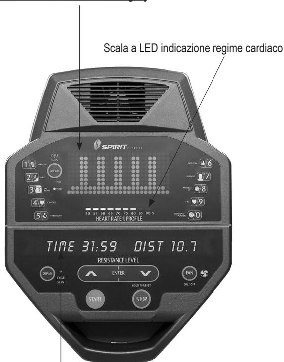
Display Informazioni: visualizzazione Time e Distance, Pulse e Calories, Speed (RPM) e MPH, Work level e Watts, METs [Display alfanumerico a LED con segmenti rossi]
